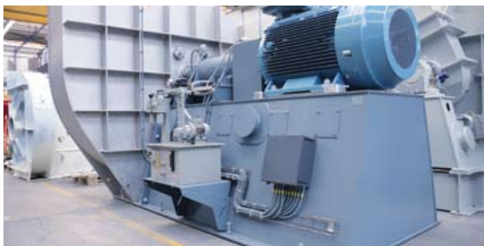
Vapour compression Photo: Piller Industrieventilatoren GmbH
